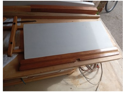
Dépose, ponçage, réparation et peinture des bancs du cockpit
