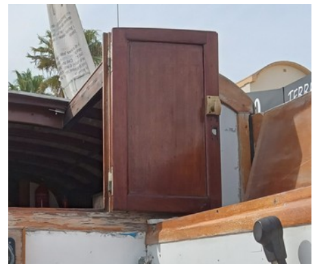
Dépose, ponçage, réparation et vernissage des portes
