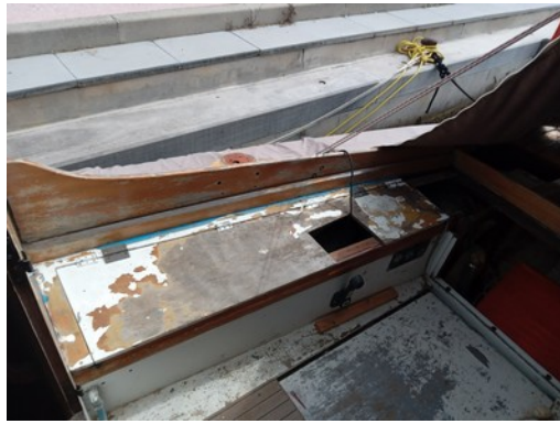
Dépose, ponçage, réparation et peinture des bancs du cockpit
