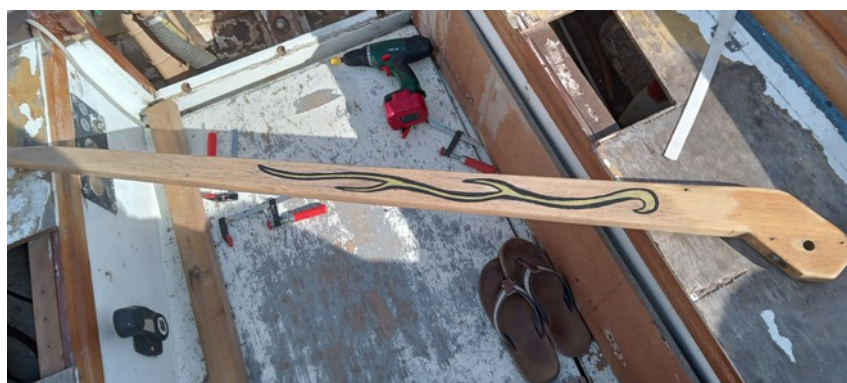
Préparation et vernissage des taquets et de la barre
